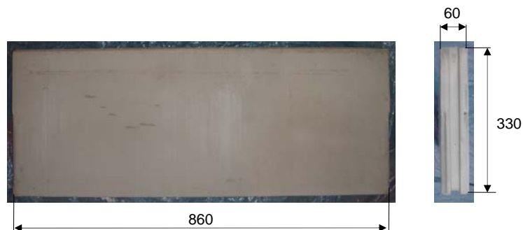
Figura 2: Dimensiones del bloque “Lateroyeso 6 LS” (Cotas en mm)
