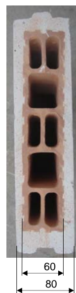
Foto 2: Sección transversal de bloque “Lateroyeso 8 LD” (cotas en mm)
