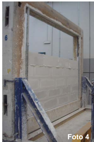
Fotos 3 y 4: Construcción de fábrica de bloque “Lateroyeso 8 LD” sobre banda perimetral
