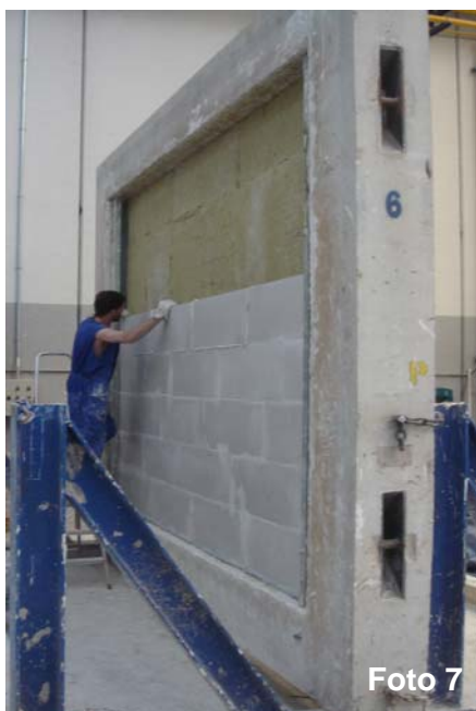
Foto 7: Construcción de fábrica de bloque "Lateroyeso 6 LS" sobre banda perimetral
