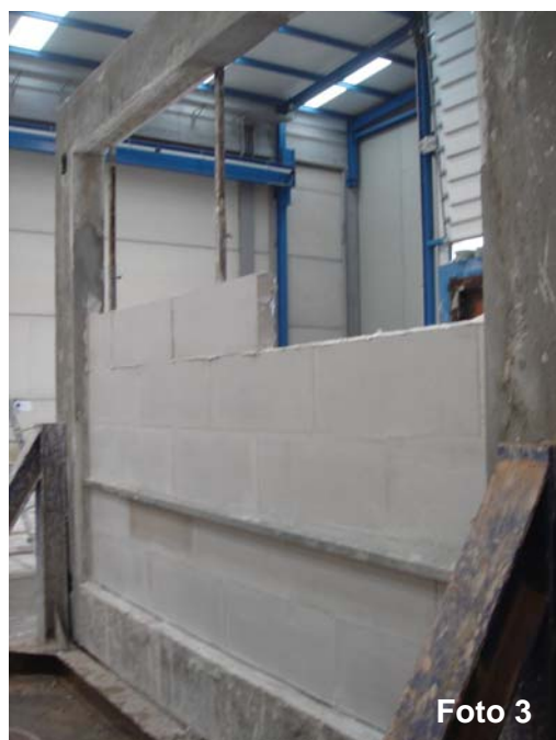
Fotos 2 y 3: Construcción de fábrica de bloque “Lateroyeso 8 LD” sobre banda EEPS inferior
