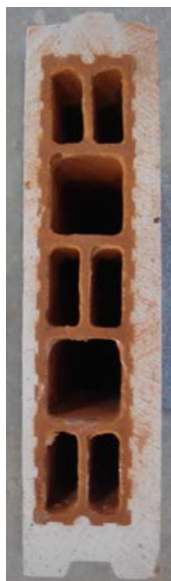
Foto 1: Sección transversal de bloque “Lateroyeso 8 LD”
