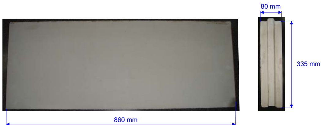
Figura 2: Dimensiones medidas de bloque "Lateroyeso 8 LD"
