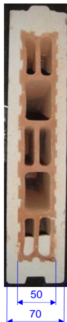
Foto 1: Sección transversal de bloque “Lateroyeso 7 LD” (cotas en mm)
