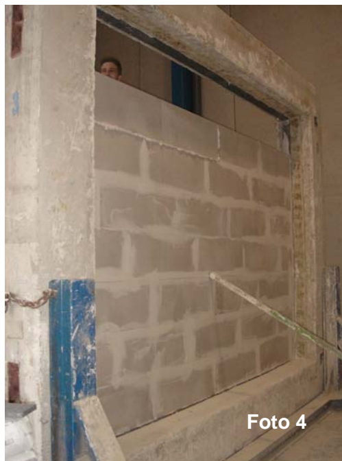
Fotos 3 y 4: Construcción de fábrica de bloque “Lateroyeso 7 LD” sobre banda perimetral
