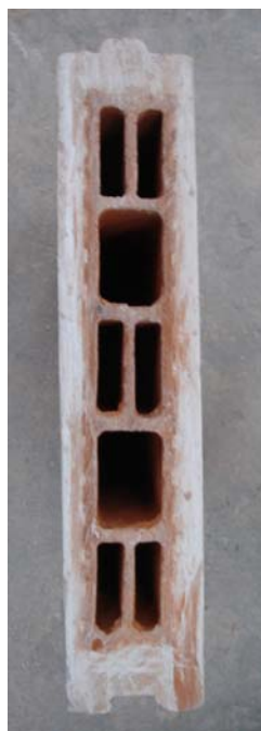
Foto 2: Sección transversal de bloque “Lateroyeso 7 LD”
