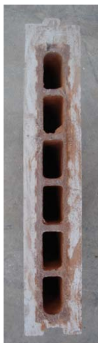
Foto 1: Sección transversal de bloque “Lateroyeso 6 LS”
