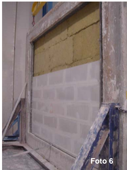
Fotos 5 y 6: Construcción de segunda fábrica de bloque “Lateroyeso 6 LS” sobre banda perimetral
