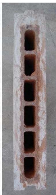
Foto 1: Sección transversal de bloque “Lateroyeso 6 LS”
